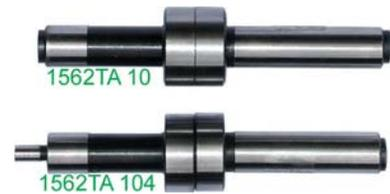
Grandezze 3 e 4 con segnale luminoso al momento del contatto col pezzo. Grandezza 5 con segnale luminoso e acustico al momento del contatto col pezzo. Completati di batteria. Strumenti utilizzati per definire i centri di foratura rispetto al mandrino della macchina e per l'allineamento delle superfici di riferimento del pezzo o dei profili. Sfere tastatrici in acciaio speciale temprato  $\varnothing$  mm 10.
